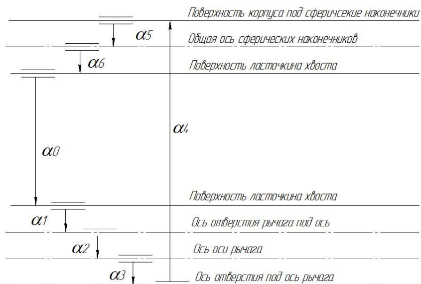
Рисунок 4.10 - Размерная цепь, описывающая погрешность, вносимую приспособлением в результат контроля
